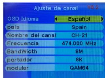
**Nombre del canal:** mediante las teclas ◀▶ permite seleccionar el canal de salida.
